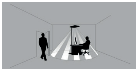
Fig. 16: Erfassungsbereich PIR Sensor.
