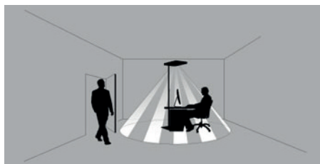
Fig. 16: Area di rilevamento sensore PIR.
