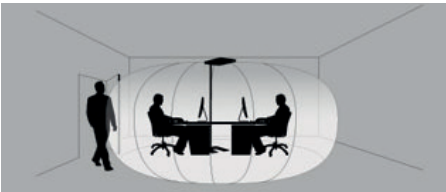
Fig. 18: Zone de détection de HFMD.
