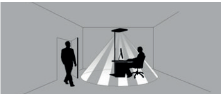
Fig. 19: Zone de détection de PIR.
