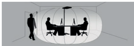
Fig. 9: Campo d'azione di HFMD sensore.
