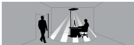
Fig. 10: Zone de détection de Détecteur PIR.
