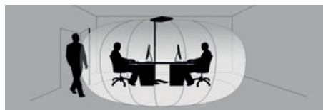
Fig. 9: Zone de détection de Détecteur HFMD.
