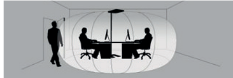
Fig. 9: Erfassungsbereich HFMD Sensor.
