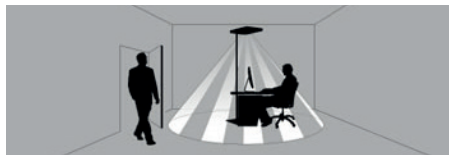
Fig. 10: Campo d'azione di PIR sensore.
