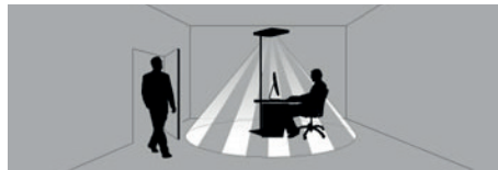
Fig. 10: Erfassungsbereich PIR Sensor.
