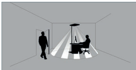
Fig. 31: Area di rilevamento del sensore PIR.
