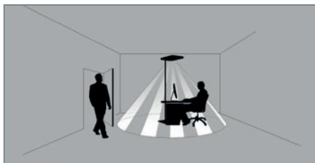
Fig. 31: Zone de détection du capteur PIR.
